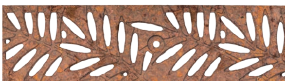
Designrist, LEAF , støpejern, ubehandlet Belastningsklasse: C250, lengde: 50 cm, SW 5 - 9 mm
