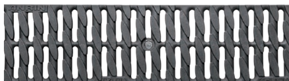
Slisset komposittrister, OvalGrip Design, svart Belastningsklasse: C250, lengde: 50 cm, SW 8 mm
