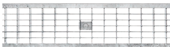
Gitterrister , galvanisert eller rustfritt stål Belastningsklasser: B125, C250, D400, lengde: 50 cm / 100 cm MW 30 x 14 mm / 30 x 10 mm / 20 x 14 mm
