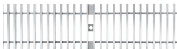
Tversgående rister , galvanisert eller rustfritt stål Belastningsklasse: B125, lengde: 50 cm / 100 cm, SW 13 mm
