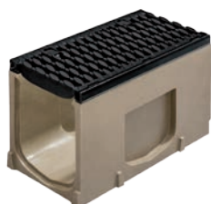
SOLID BLOCK 200 Tilkomstenhet med støpejernsrist OvalGrip Design kl. F900
