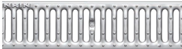
Slisset stålrister, Dobbel slisset stålrister , galvanisert eller rustfritt stål Belastningsklasser: A15, C250, lengde: 50 cm / 100 cm, SW 10 mm
