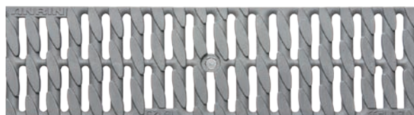
Slisset komposittrister, OvalGrip Design, grå Belastningsklasse: B125, lengde: 50 cm, SW 8 mm
