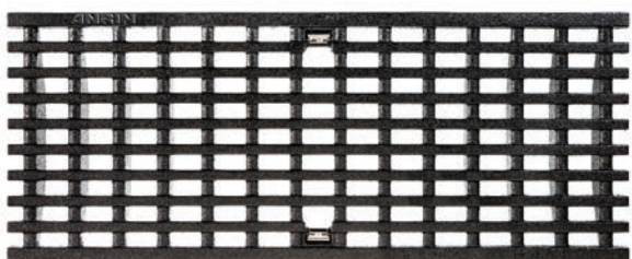
Langsgående rist , støpejern Belastningsklasser: D400*, E600*, lengde: 50 cm, MW 25 x 11 mm
